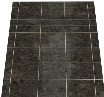
Stengolv med fyrhörnsläggning
