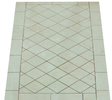
Stengolv med diagonal läggning och fris
